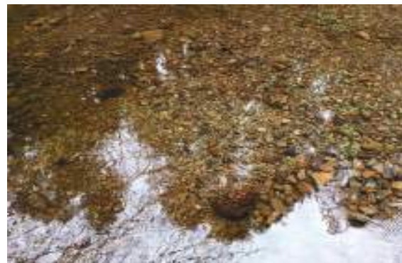
Cailloux peints (en vert) mélangés aux sédiments réinjectés, de manière à suivre leur déplacement au gré des crues
